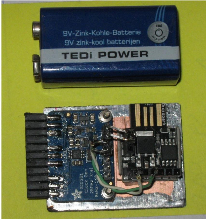
Größenvergleich des Bausteins im Vergleich zu einem 9V Block. Die Programmierung des Digispark erfolgt über den USB-Stecker.
